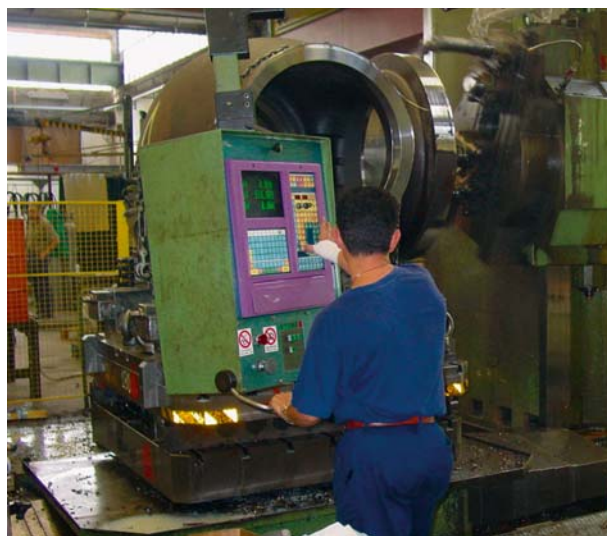
Valvola di ritegno da 32" in lavorazione su centro di lavoro CNC
